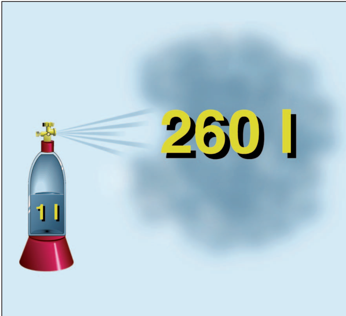
Bild 12: Volumenzunahme beim Verdampfen von Propan
