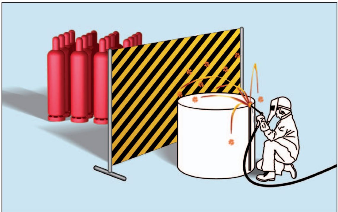
Bild 45: Besondere Schutzmaßnahmen beim Schweißen in explosions- und brandgefährdeten Bereichen
