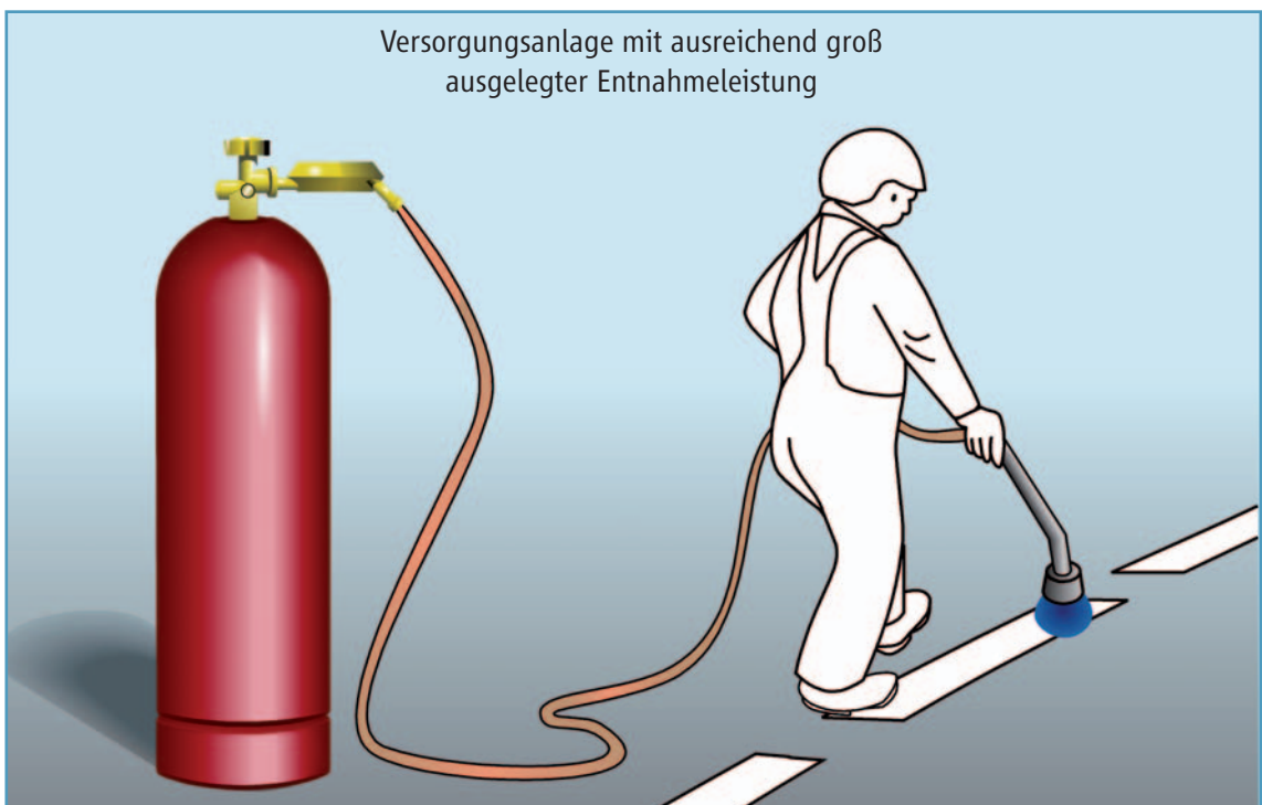
Bild 25: Maßnahme zum gefahrlosen Sicherstellen der Entnahmeleistung
