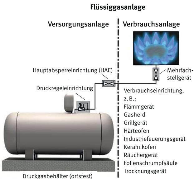
**Abb. 2** Flüssiggasanlage mit Versorgung aus ortsfestem Druckgasbehälter (Flüssiggasbehälter)
