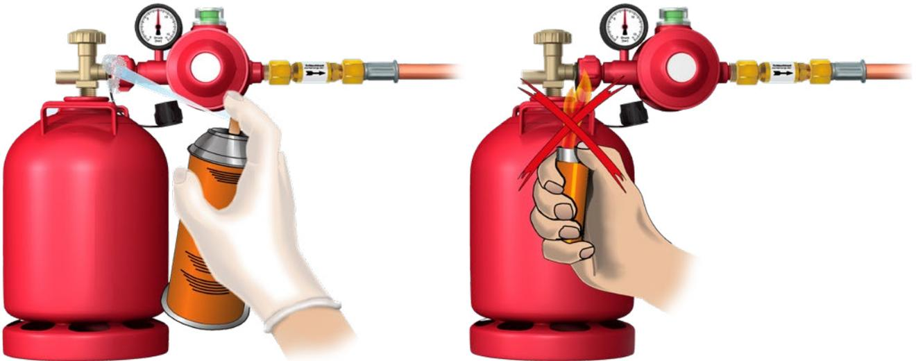
Abb. 29 Dichtheitskontrolle mittels Lecksuchspray nach Anschluss der Druckregleinrichtung an die Flüssiggasflasche
